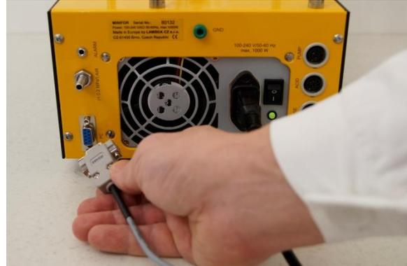
**Figura 2** Conecte el cable de conexión a PC al enchufe DB 9 en la parte trasera de la unidad de control del MINIFOR.
