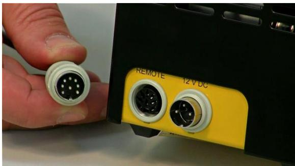
**Figura 6** Desconecte el cable de control remoto de 8 polos de la bomba peristáltica y mientras mantiene el botón de la dirección ◀▶ presionado conecte nuevamente el cable de 8 polos a la bomba.
