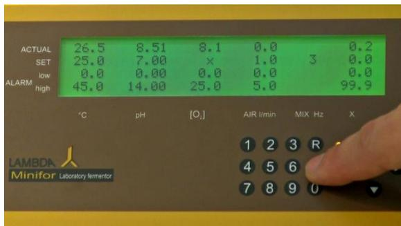
**Figura 4** Presione el botón “C” en el panel de control del MINIFOR para entrar al **modo de Calibración** para fijar o controlar la dirección del MINIFOR para el control desde la PC.
