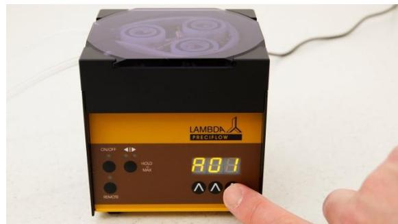
**Figura 7** El mensaje “A” y dos números aparecerán en la pantalla, estos corresponden a la dirección actual de la bomba. Presione los botones ▲▲ debajo de la pantalla para modificar la dirección. Presione el botón **ON/OFF** para salvar la dirección introducida.
