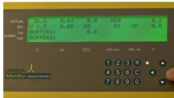
**Figura 5** ADR en el parámetro Air l/min es la dirección del Fermentador-bioreactor MINIFOR.
